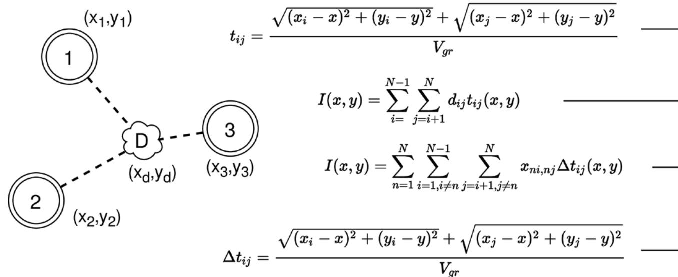
Schadenslokalisierung mit Multitransducernetzwerk (nach Croxford, 2008) (Oben) Elliptisches Verfahren (Unten) Hyperbolisches Verfahren
